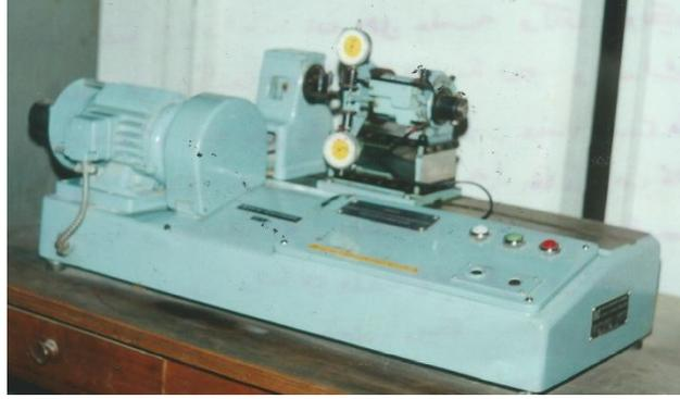
الشكل رقم (٣):جهاز اختبار الكلال Fatigue Test Machine
